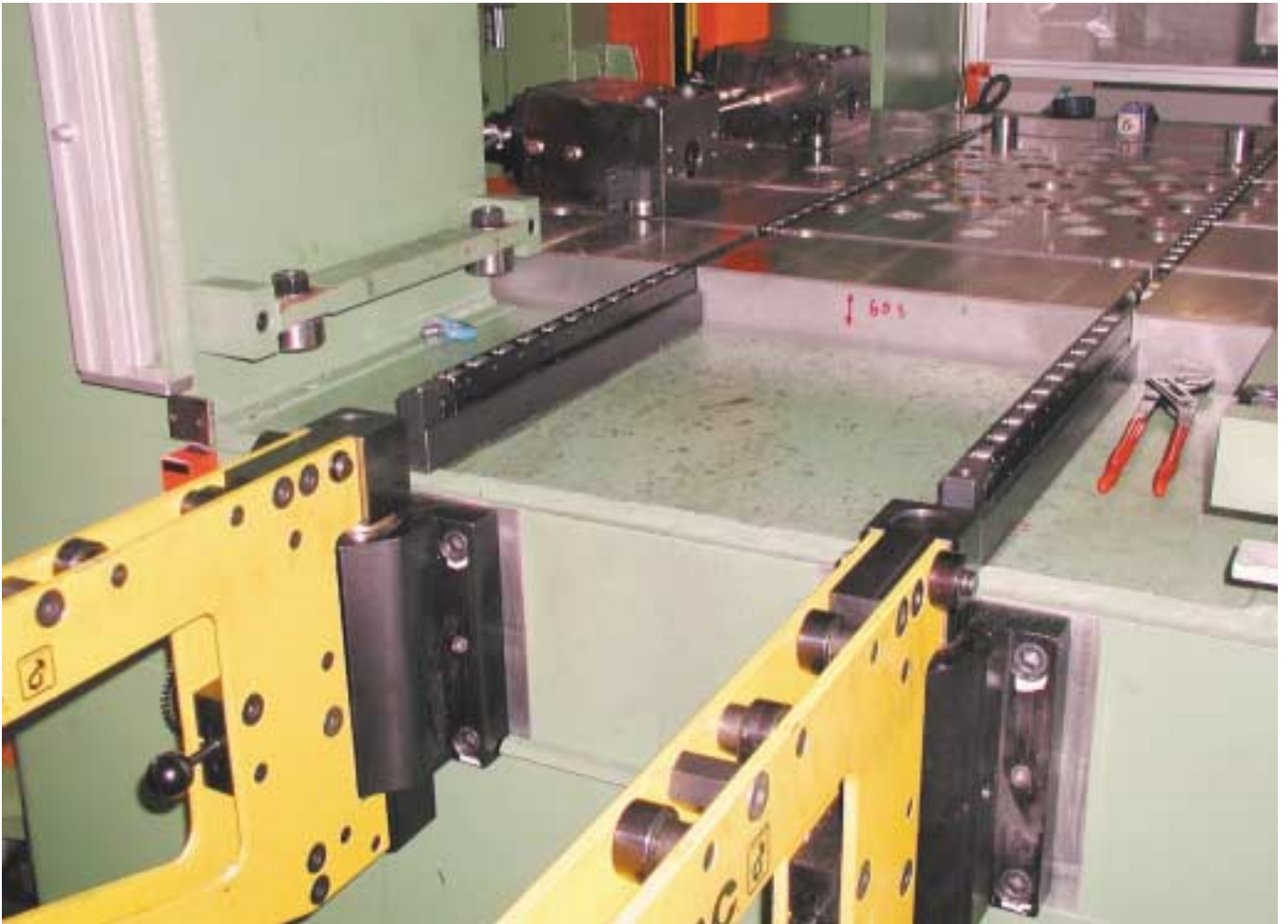
Esempio applicazione barre a rulli su piano macchine.
